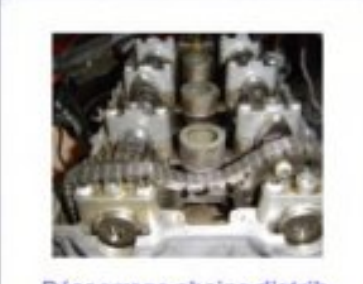
Désserrage chaîne distrib
