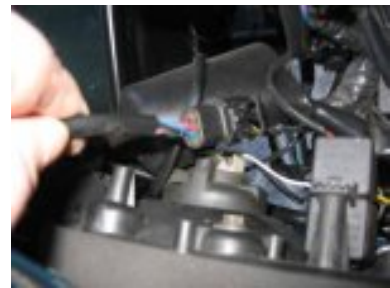
débrancher connecteurs électriques des deux clignotants avants
