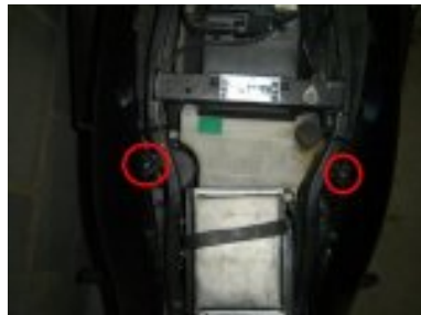
revisser vis interieur caches lateraux
