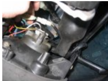
débrancher connecteurs électriques lié à l'éclairage
