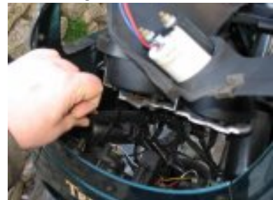
débrancher connecteurs électriques des deux clignotants avants
