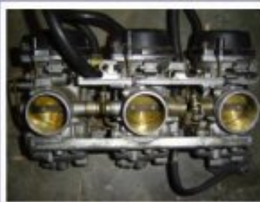
Démontage carbu et boîte à air
