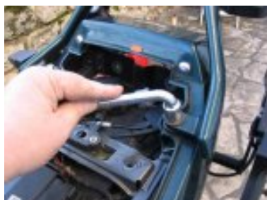
démontage de la poignée centrale ar
