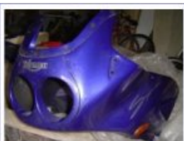
Démontage carénage avant
