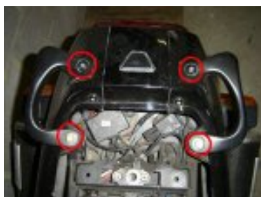
démontage des deux poignées Ar
