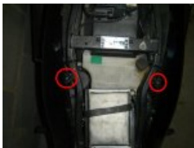
revisser vis interieur caches lateraux
