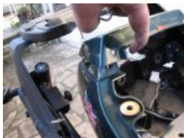
désserage fixations sur caches lateraux vis + clips
