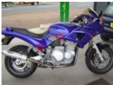
reclipser les caches lateraux
