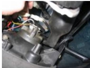
débrancher connecteurs électriques lié à l'éclairage
