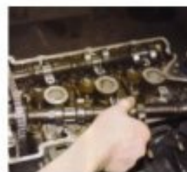
Remontage des arbres à cames
