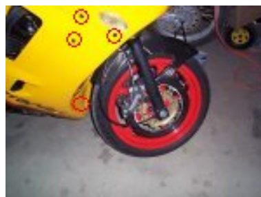
démontage du sabot
