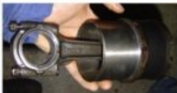
Démontage des chemises
