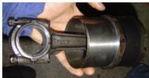
Démontage des chemises
