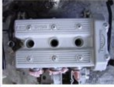
Démontage couv arbres à cames
