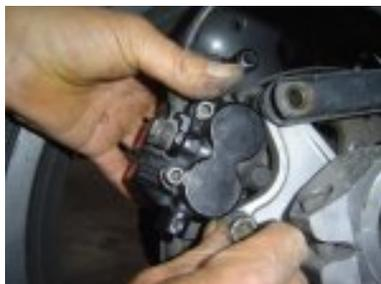
7. serrer les vis de fixation de l'étrier au couple de 4.0m.daN à l'aide d'une clé dynamométrique
