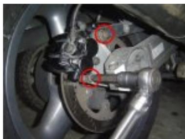
8. serrer les petites vis du dessus au couple de 1.8m.daN à l'aide d'une clé dynamométrique : ce sont les axes de maintien des plaquettes
