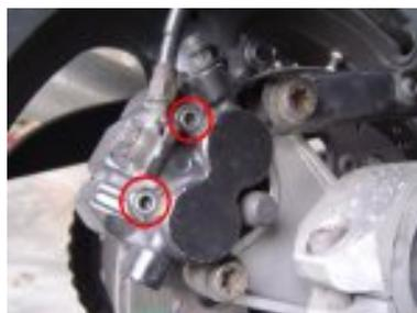
9. vérifier que les plaquettes viennent correctement au contact du disque en appuyant par petits coups sur la pédale de frein.
