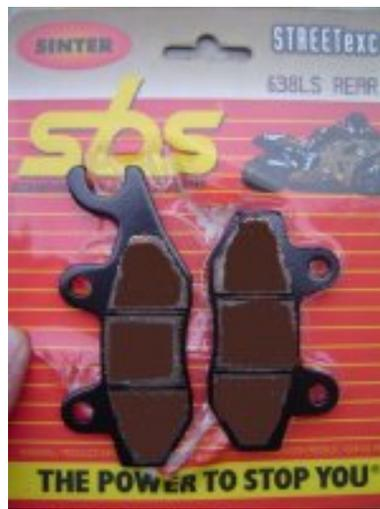
4. mettre en place les nouvelles plaquettes : mettre la plus petite côté pistons et celle avec l'accroche vient se loger sur la vis
