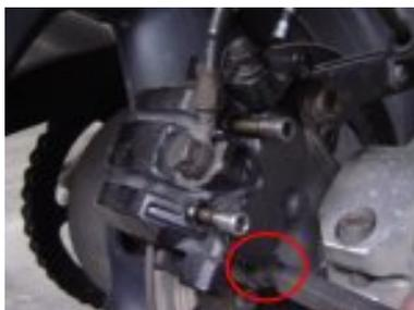
3. Protéger au préalable avec un chiffon ou avec un bout de bois et écarter légèrement les plaquettes afin d'enfoncer les pistons à l'aide d'un tournevis .
