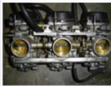
Démontage carbu et boîte à air
