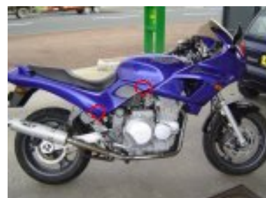
declipser les caches latéraux
