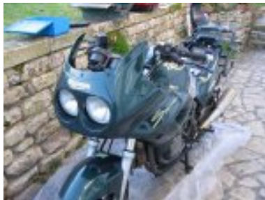
déposer les 2 clignotants avant
