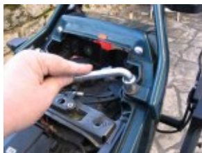
démontage de la poignée centrale ar
