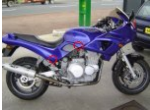
reclipser les caches lateraux
