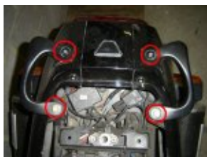
démontage des deux poignées Ar
