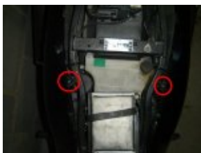
dévisser vis interieur caches lateraux
