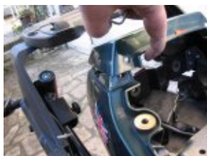
désserage fixations sur caches lateraux vis + clips
