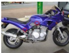
déclipser les caches lateraux
