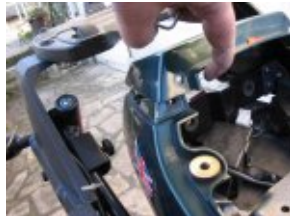
resserage fixations sur caches lateraux vis + clips
