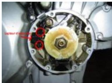
7. mettre de la graisse siliconée sur la virole des fils du capteur puis installer la virole dans son logement sur le carter moteur
