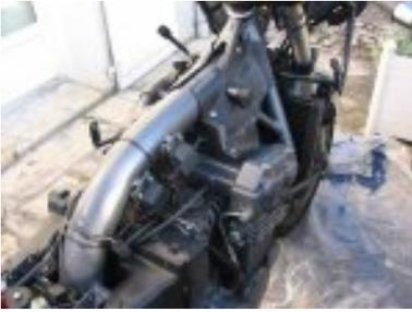
7. soulever la partie arrière du réservoir puis le faire glisser vers l'arrière de la moto afin de le dégager de ses pattes d'ancrage avant.
