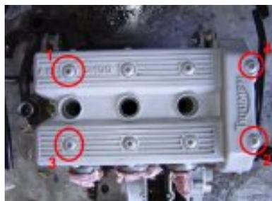
3. retirer les vis de fixation avec leur rondelle-joint
