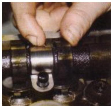
7. 1ere vérification: examiner les portées des paliers et au niveau de la culasse . Il ne doit pas y avoir de rayures, de trace de chauffe (signe d'un défaut de lubrification)
