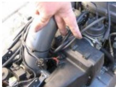
8. remettre les conduits d'admission d'air aux chambres auxiliaires au niveau des 2 vis
