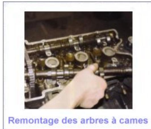
1. vérifier que l'on a bien la position T1 aligné avec le centre du capteur d'allumage
