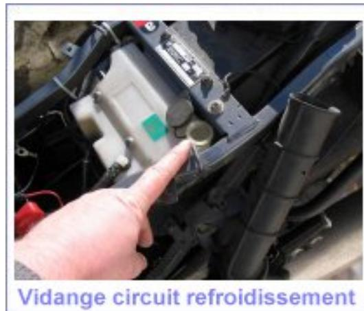
1. Dévisser le bouchon du radiateur, tout en appuyant dessus. Ce bouchon est à double crantage 1er cran (évacuation de la pression) ; 2ème cran (ouverture) (moteur froid !)
