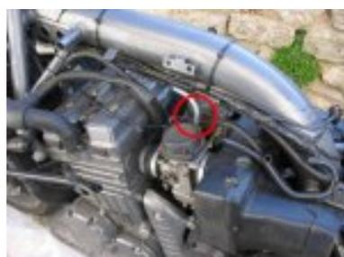
4. remettre le cable d'accelerateur au niveau de la poignée
