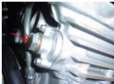
5. veiller à bien récupérer la vis obturateur, sa rondelle d'étanchéité et le ressort de poussée du tendeur.
