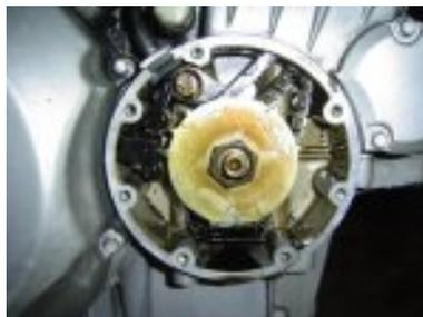
2. faire tourner le vilebrequin avec une clef de 24 dans le sens des aiguilles d'une montre pour mettre le piston du cylindre 1 en position haute
