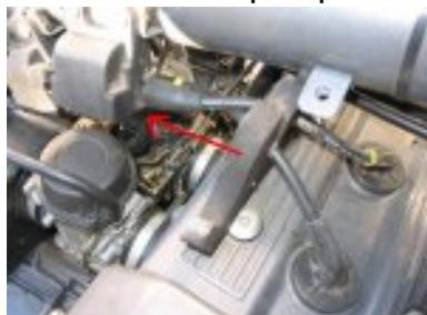
3. rebrancher les fils d'alimentation au niveau des 3 bobines
