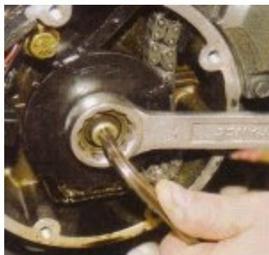
3. tout en tenant l'écrou à l'aide d'une clé plate de 24, serrer la vis de fixation du doigt d'allumage au couple de serrage de 2.8 m.daN
