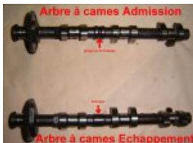
3. poser en 1er l'arbres à cames d'échappement dans ses 1/2 paliers de culasse.
