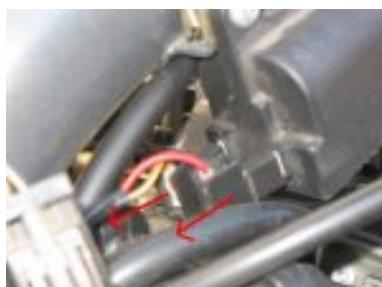
7. débrancher les anti-parasites (fils reliés aux bougies au niveau des bobines)
