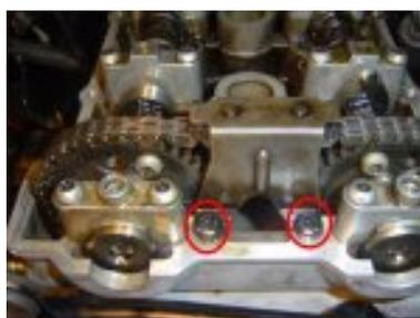
4. remettre en place la plaque déflecteur d'huile avec serrage au couple de 1.2 m.daN à l'aide d'une clé dynamométrique
