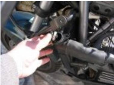
2. Retirer la vis de vidange du circuit au niveau de la pompe à eau
