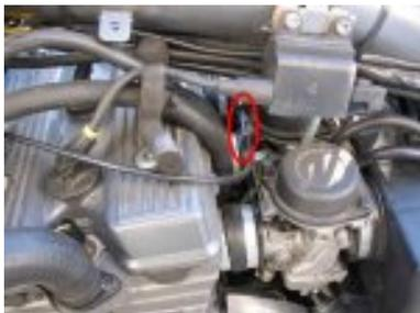
6. resserrer les colliers des pipes d'admission du boitier à la rampe de carburateur et remettre la boîte à air au niveau des carburateurs
