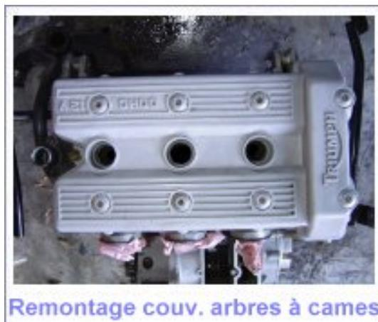
1. vérifier l'état de tous les joints, y compris des vis du couvercle d'arbre à cames. Remplacez-les si nécessaire
