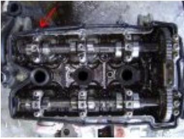
7. bien conserver les joints d'étanchéité au niveau des puits de bougies
