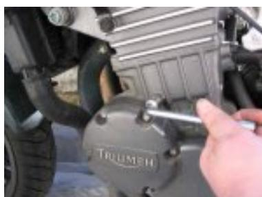
2. visser la vis de vidange sur la pompe à eau au couple de 1.2 m.daN ne pas oublier les rondelles d'étanchéité à l'aide d'une clé dynamométrique
