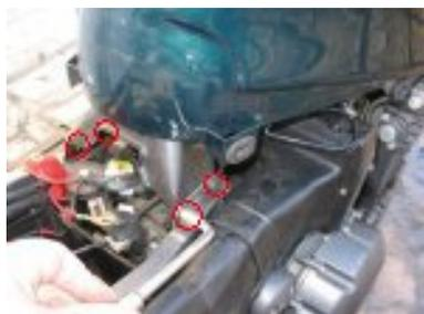
3. soulever le réservoir au niveau de cette fixation
