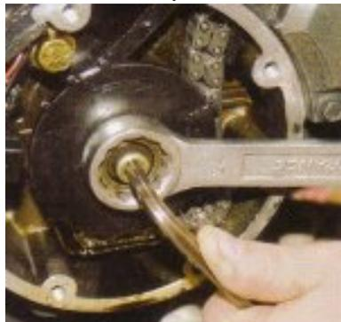
3. vérifier que l'on a bien la position T1 aligné avec le centre du capteur d'allumage
