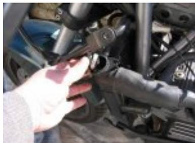
6. remplir le bocal d'expansion jusqu'au repère " U " (Upper) et remettre son bouchon
