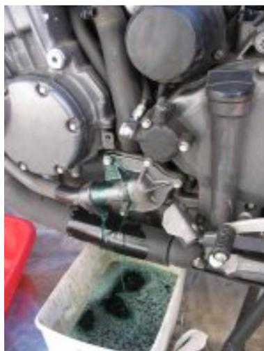
4. Une certaine quantité de liquide de refroidissement reste dans le bloc cylindres. Afin de vidanger ce dernier, déposer la vis de vidange du bloc cylindres coté gauche de ce dernier
