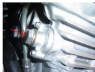
3. installer le patin guide chaîne supérieur au couple de 1.2 m.daN à l'aide d'une clé dynamométrique
