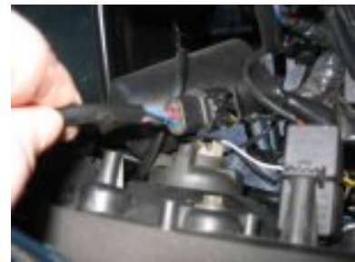
brancher connecteurs électriques des deux clignotants avants
