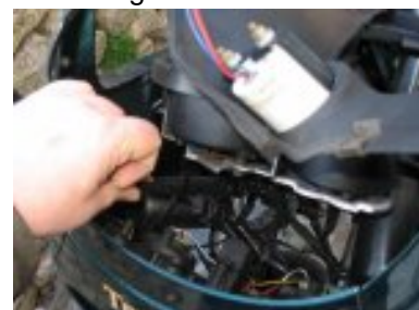
débrancher connecteurs électriques des deux clignotants avant
