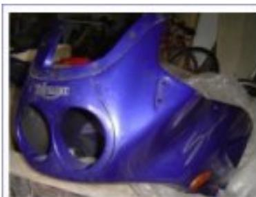
Démontage carénage avant
