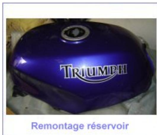
1. soulever la partie arrière du réservoir puis le faire glisser vers l'avant de la moto afin de le placer dans ses pattes d'ancrage avant.
