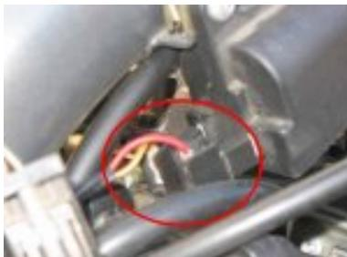
6. débrancher les fils d'alimentation au niveau des 3 bobines
