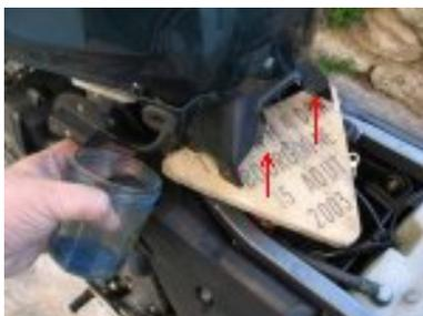
4. débrancher la connectique de témoin de réserve située à droite du réservoir
