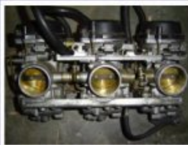
Démontage carbu et boîte à air
