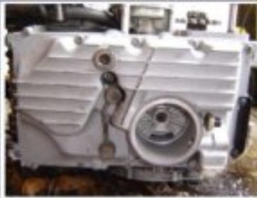
Démontage carter inférieur
