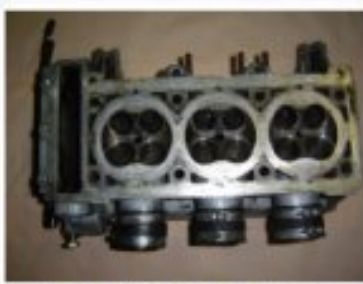
Démontage de la culasse
