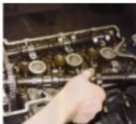
Remontage des arbres à cames
