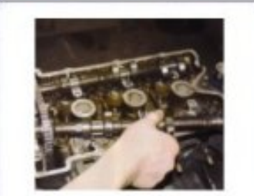
Démontage arbres à cames
