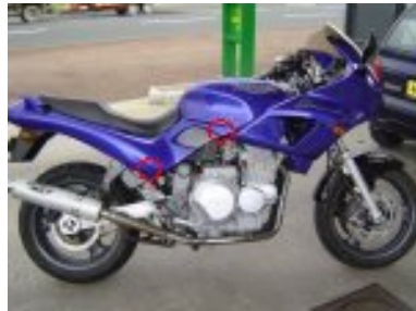
reclipser les caches lateraux
