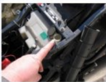
Vidange circuit refroidissement
