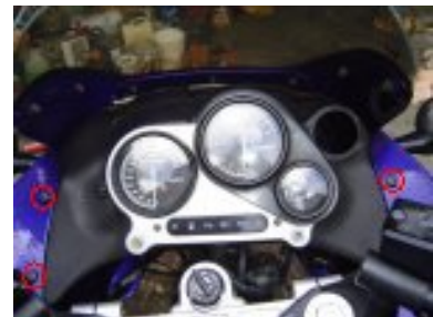
retirer panneaux d'habillage interne du carénage tête de fourche en desserrant les vis
