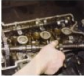
Remontage des arbres à cames
