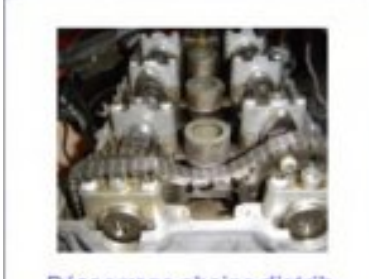
Désserrage chaîne distrib
