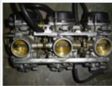
Démontage carbu et boîte à air
