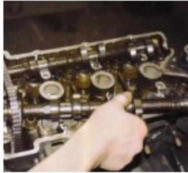
Démontage arbres à cames
